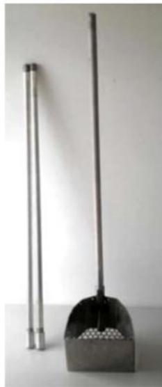
Figura 23 - Concha raspadora para coleta de incrustações do mexilhão-dourado. Fonte: Pereira et al., 2012.
