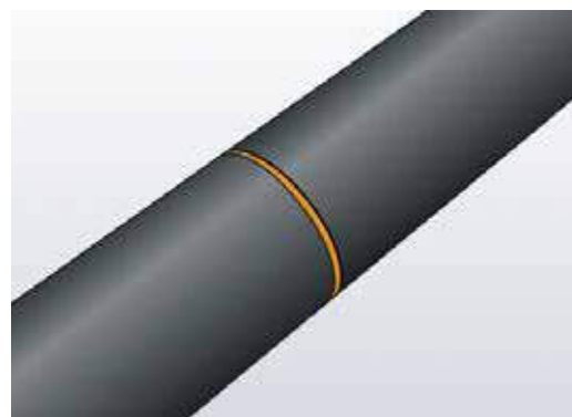
Imagem 67: Finalmente, conecte os tubos de isolamento.
