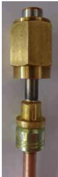
Imagem 58: Exemplo de "plugue de vedação" como conector de pressão.
