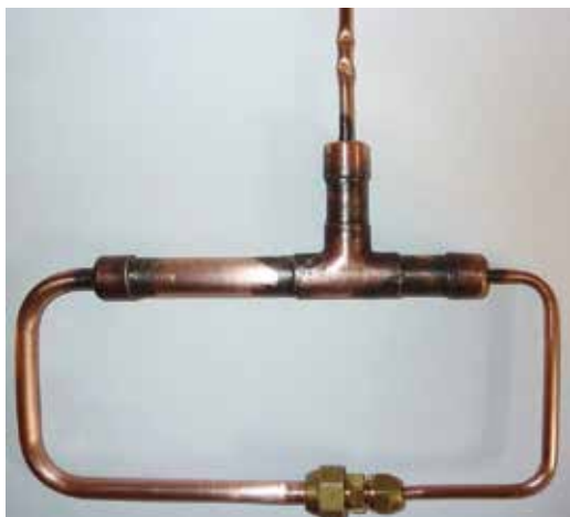
Imagem 60: Amostras de verificação de brasadores (incluindo encurvamento e flangeamento).
