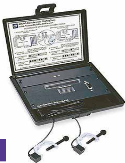
Imagem 19: Visor de líquido eletrônico para fins de serviço.
