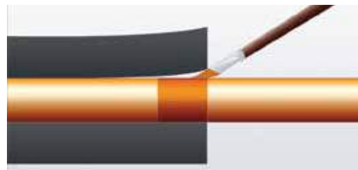
Imagem 66: Aplicação de adesivo em ambos os lados das juntas.
