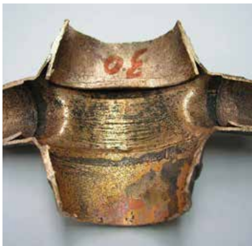
Imagem 61: Exemplo de inspeção da amostra (por corte lateral).
