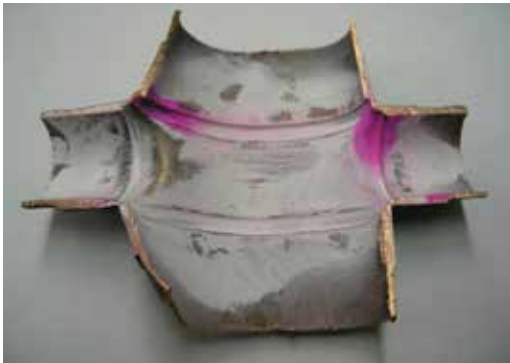
Imagem 62: Exemplo de inspeção da amostra (por corte lateral e teste de penetração de matriz).
