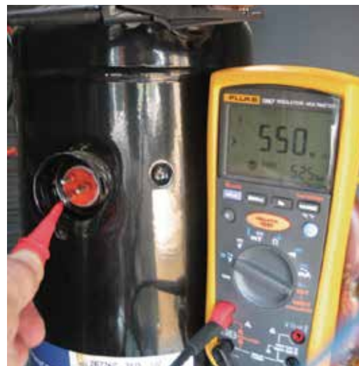
Imagem 12 e 13: Medição em compressor scroll hermético com CA.
