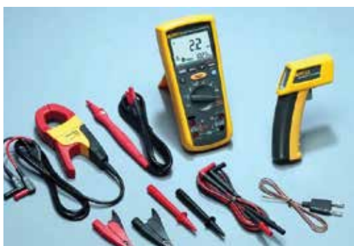
Imagem 11: Conjunto de dispositivo de medição de teste elétrico e resistência de isolamento.
