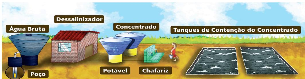
**Figura 3.7. Desenho esquemático do Sistema de dessalinização simplificado do Programa Água Doce**
