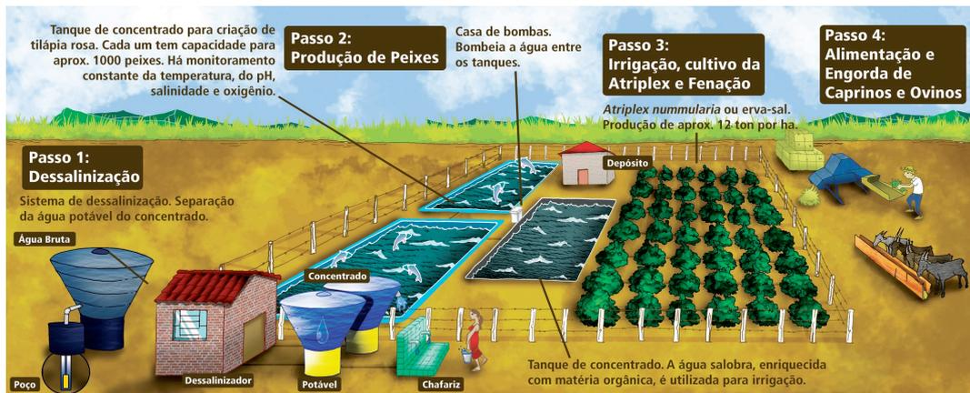
**Figura 3.8. Desenho esquemático do Sistema de dessalinização integrado a produção do Programa Água Doce**
