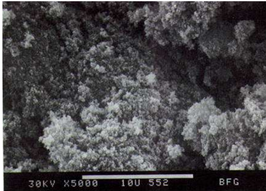
Figura 13. Sílica (Microscopia eletrônica de varredura, 5.000X).
