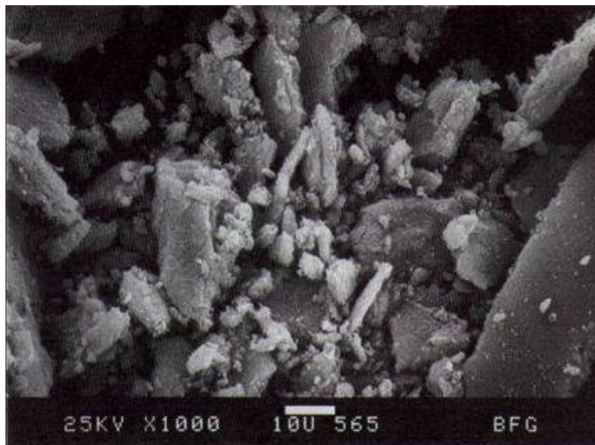
Figura 14. Argila (Microscopia eletrônica de varredura, 1.000X).
