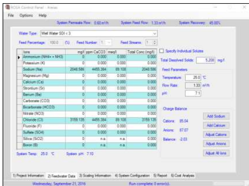
Figura 22. Janela “Feedwater Data” da interface do Software ROSA 9.1 (Filmtec), preenchida com a concentração de TDS em mg/L apresentada para a água do poço da comunidade Areias no município de Porto da Folha/SE.
