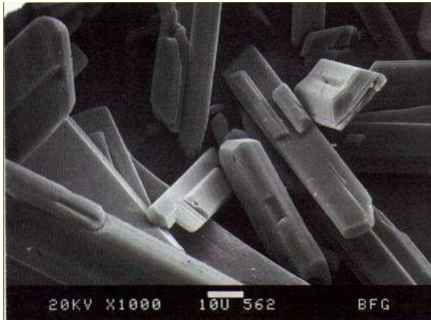
Figura 15. Cristais de sulfato de cálcio hidratado (Microscopia eletrônica de varredura, 1.000X).
