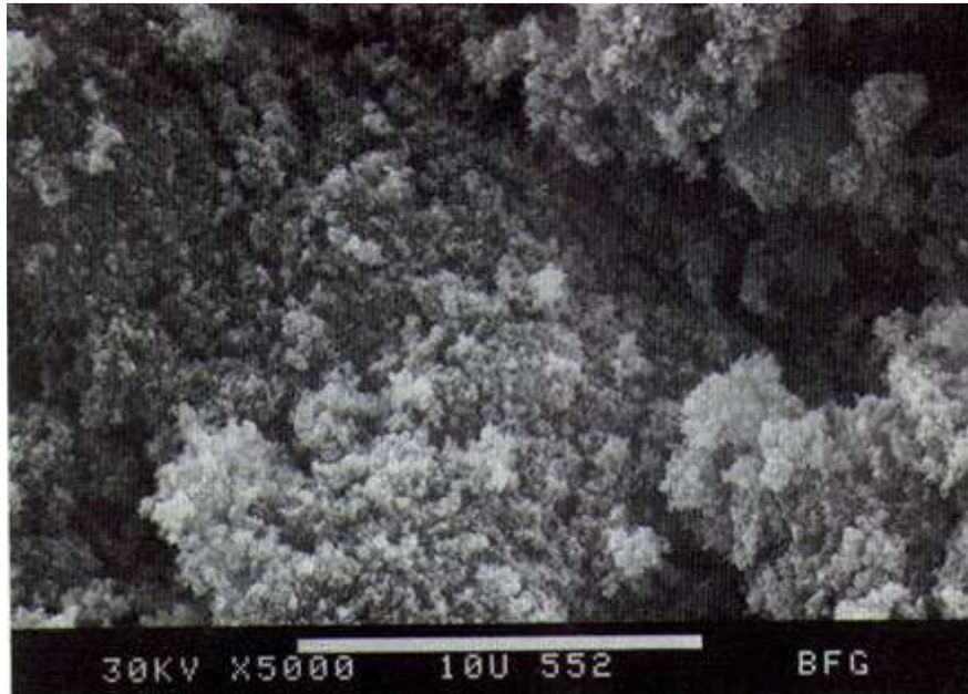
Figura 13. Sílica (Microscopia eletrônica de varredura, 5.000X).
