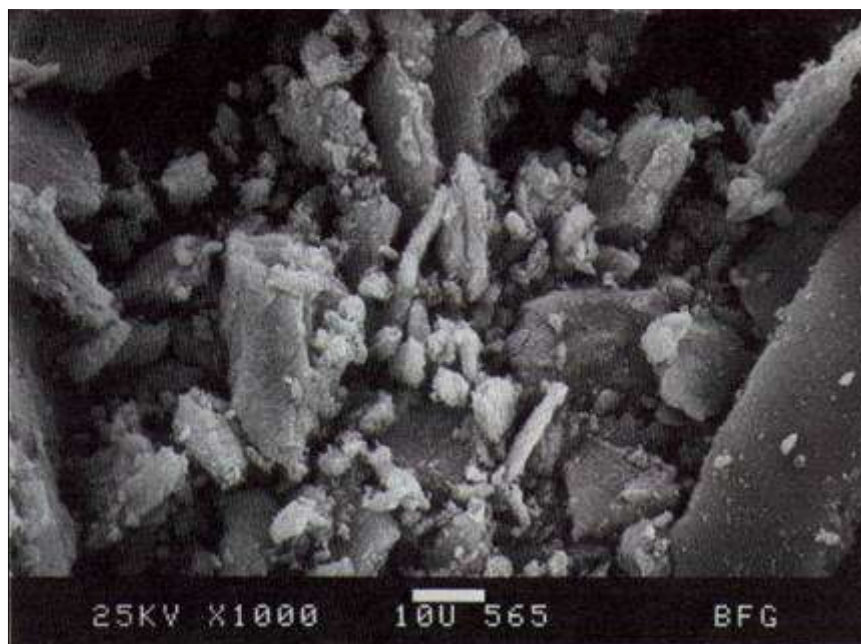
Figura 13. Sílica (Microscopia eletrônica de varredura, 5.000X).
