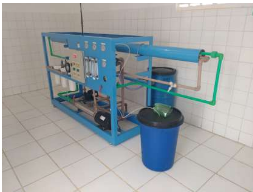
Figura 34. Equipamento de dessalinização da comunidade Calvário.
