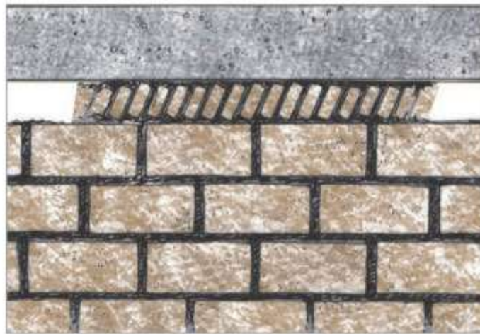
Encunhamento com tijolos maciços
