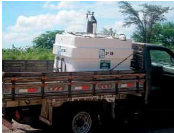
Foto 5. Caixa de transporte de peixes. Características: isolamento térmico; acoplada ao cilindro de oxigênio e capacidade de 400 a 2000L
