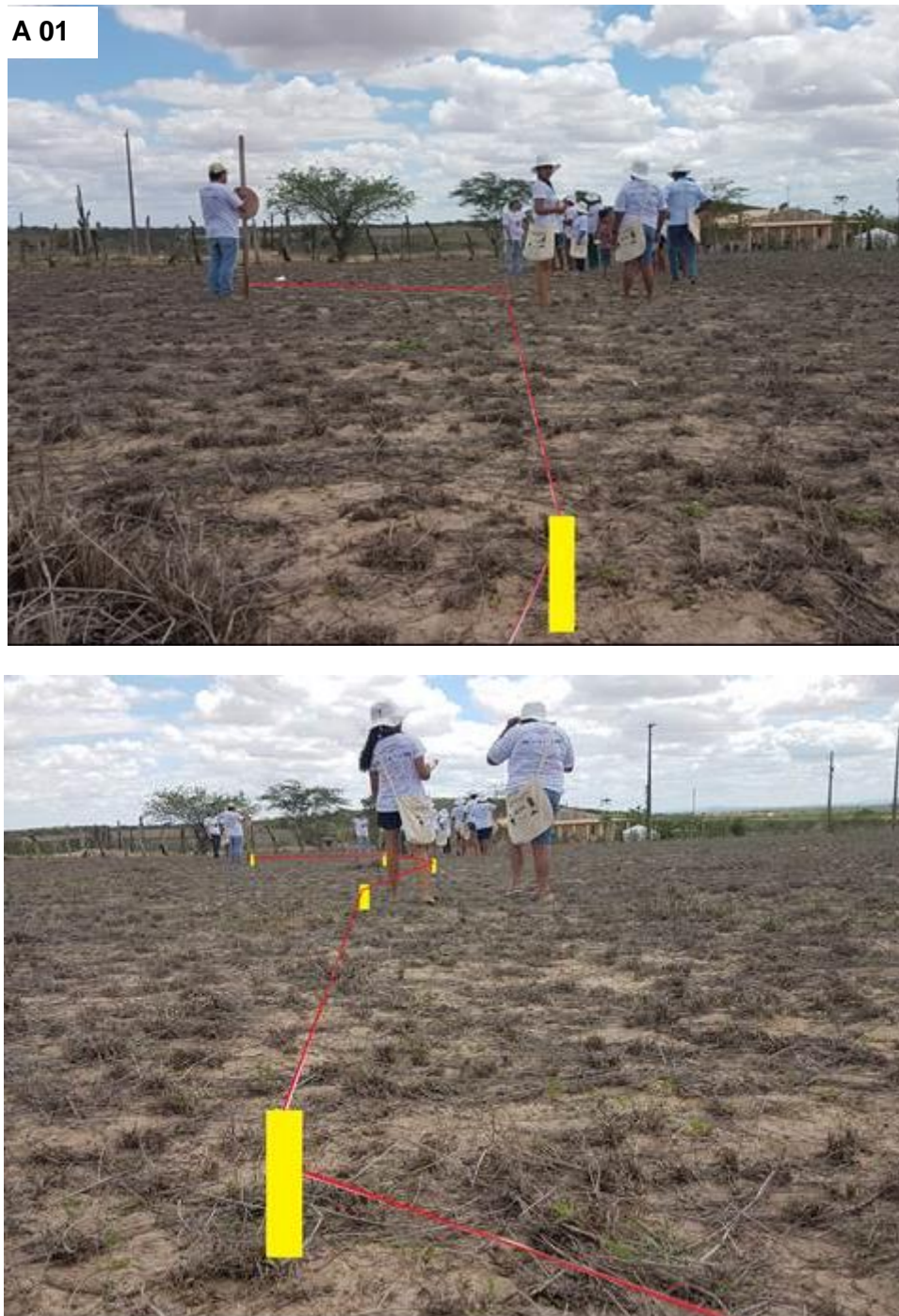
Imagem 04 – Marcação da curva de nível após uma Nivelada Básica.
