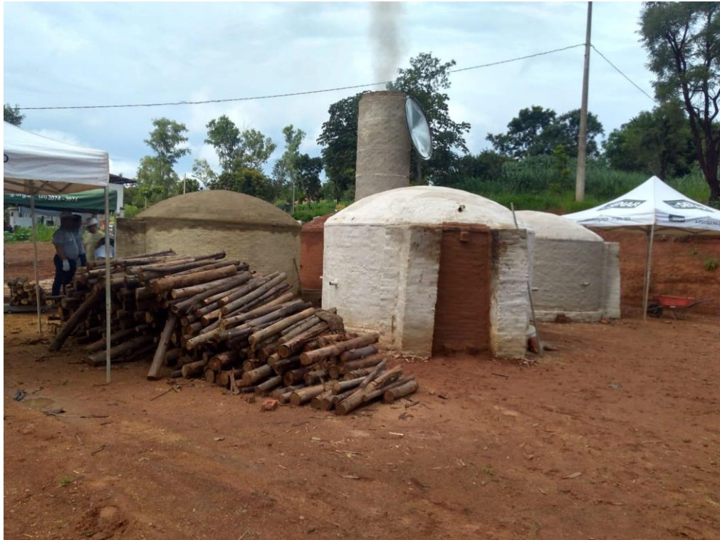
Figura 18. Forno início de processo de carbonização durante o curso teórico-prático em produção sustentável de carvão vegetal ocorrido entre 05 à 07/02/2020.
