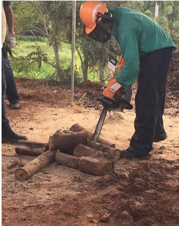
Figura 11. Amostras de madeira de eucalipto spp. sendo retiradas para determinação da umidade da madeira e após cálculo da massa seca visando o rendimento gravimétrico da carbonização.
