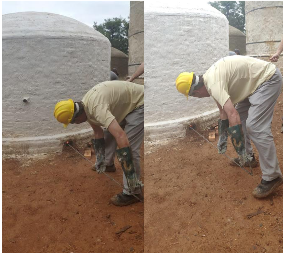
Figura 24. Introdução de um vergalhão no tatu do forno, para verificar se processo de carbonização findou.
