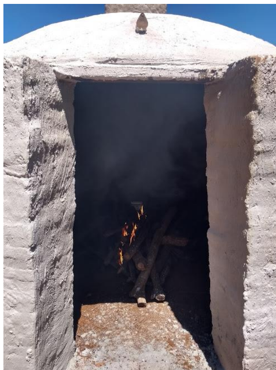
Figura 2. Processo de cura dos fornos de carbonização.
