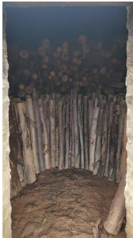
Figura 12. Forno sendo carregado durante o curso teórico-prático em produção sustentável de carvão vegetal ocorrido entre 05 à 07/02/2020.
