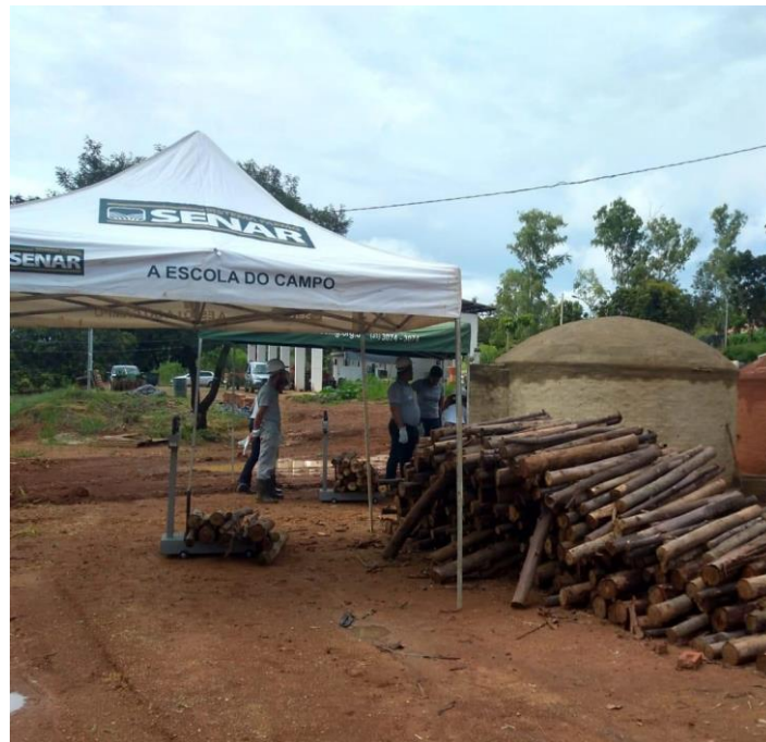
Figura 9. Madeira de eucalipto spp. empilhada para fazer a carga do forno durante o curso teórico-prático em produção sustentável de carvão vegetal ocorrido entre 05 à 07/02/2020.
