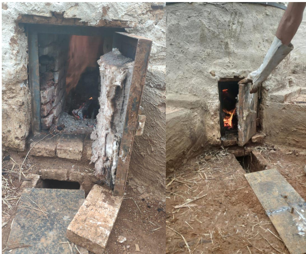
Figura 2. Fornalha queimando resíduos lignocelulósicos a fim do calor e chamas produzidos extinguirem termicamente os gases poluentes do processo de carbonização.
