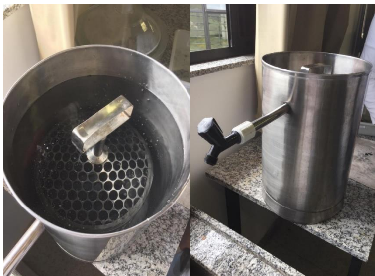
Figura 8: Representação da realização da densidade relativa aparente do carvão vegetal, utilizando massa úmida sobre volume saturado e deslocado.
