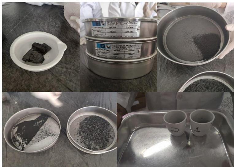
Figura 9: Representação do processo de redução granulométrica das amostras de carvão vegetal, e sua respectiva tamisação, para posteriormente serem levadas para a mufla.
