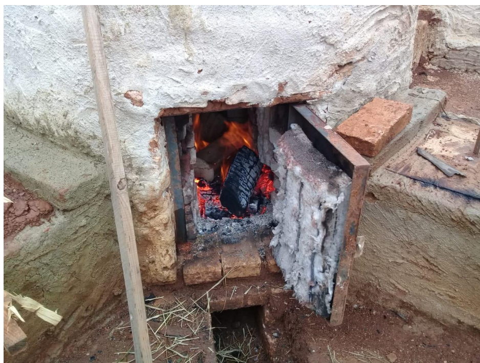
Figura 1. Fornalha queimando resíduos lignocelulósicos a fim do calor e chamas produzidos extinguirem termicamente os gases poluentes do processo de carbonização.
