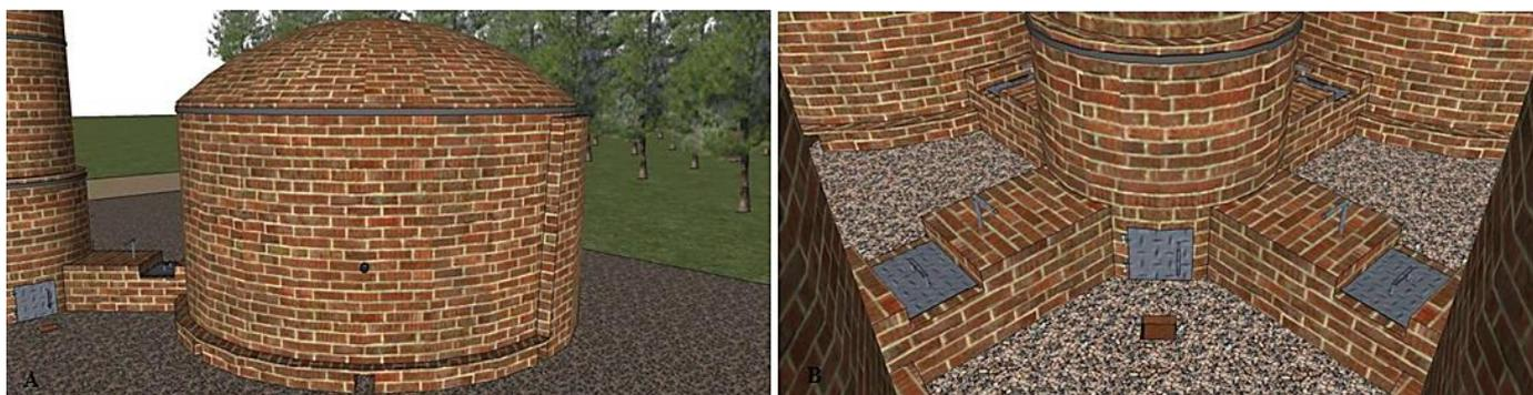
Figura 3: Forno circular com detalhe do “tatu” na porção inferior para controle do processo de carbonização, assim como do local para colocação do pirômetro medidor da temperatura no interior dos fornos (A). Ductos que ligam os fornos a fornalha para queima dos gases (B).
