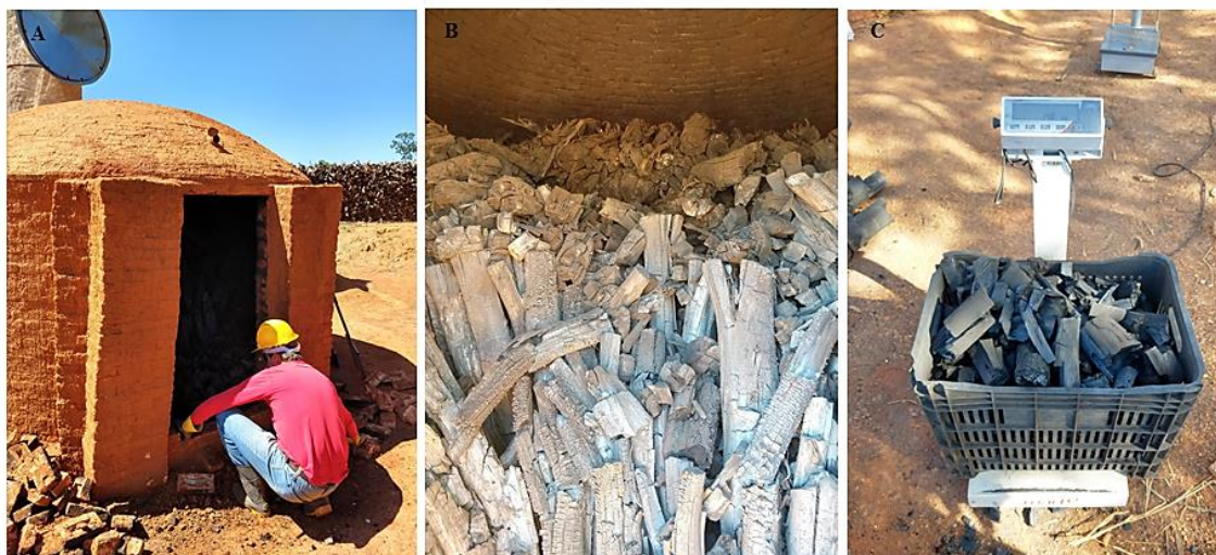
Figura 4: Abertura do forno após carbonização (A), Vista interior do forno (B), pesagem do carvão vegetal (C).
