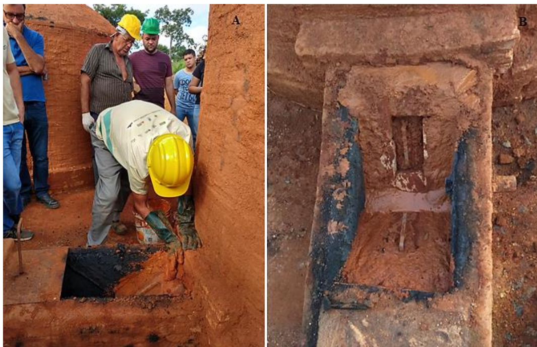
Figura 2: Vedação minuciosa para evitar a saída dos gases após finalização da carbonização da madeira e início da fase de resfriamento (A), duto que liga forno-fornalha completamente vedado (B).
