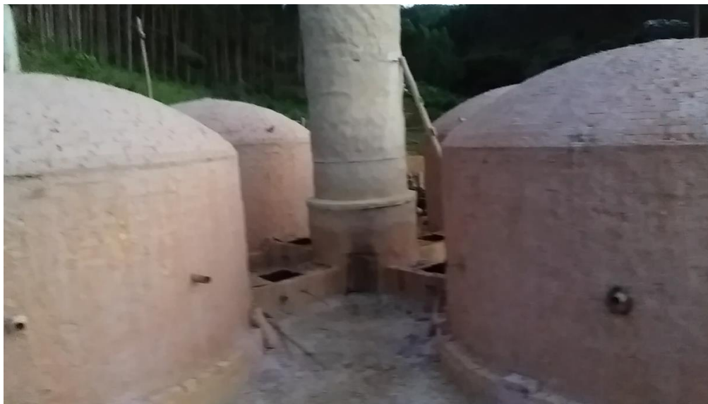
FIGURA 47: SISTEMA FORNO FORNALHA UFV- COM QUATRO FORNOS E UMA FORNALHA CENTRAL COM CHAMINÉ – POÇOS DE LEITURA DA TEMPERATURA NA UNIDADE DEMONSTRATIVA DE LAMIM
