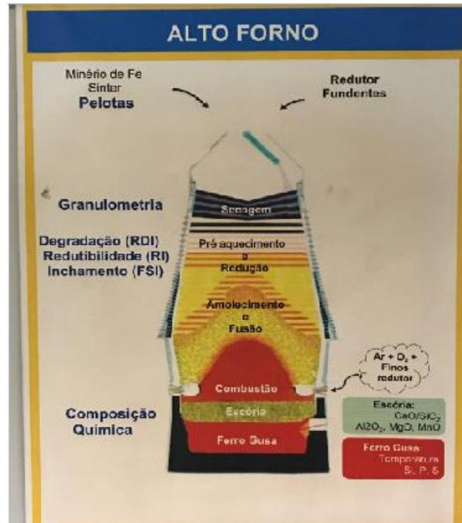
Foto 1: Esquema geral de funcionamento de um alto forno
