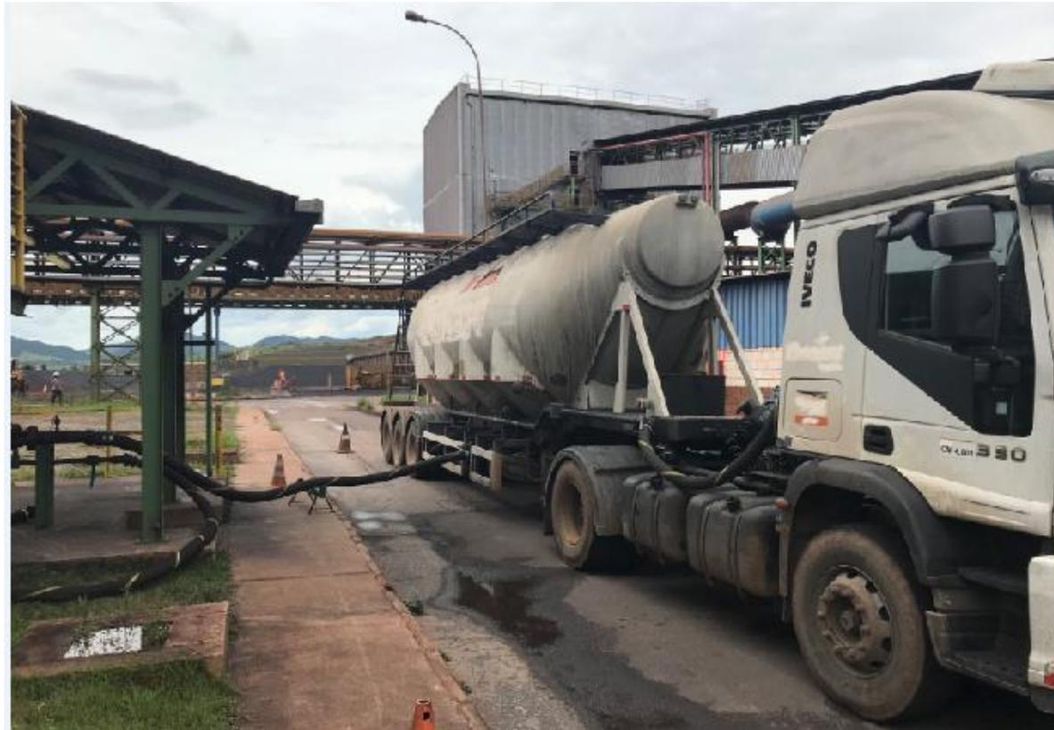
Foto 3: Descarga do pó de injeção (carvão vegetal moído) na unidade de dosagem e transferência.
