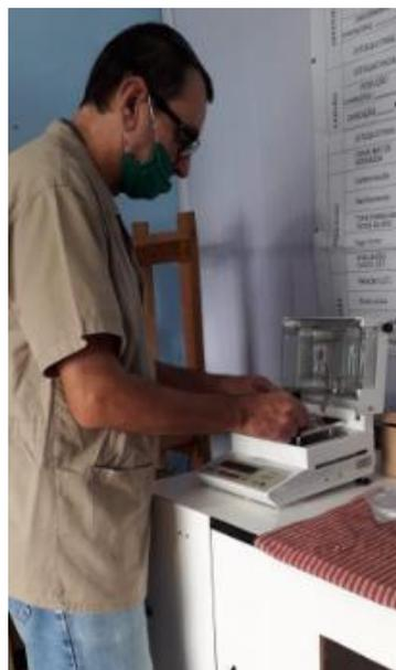
Aparato para determinação de umidade – Determinador Marte – Mod. ID 200
