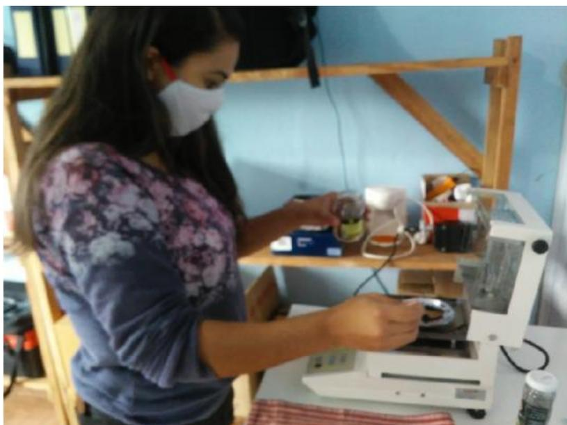
Determinação da umidade da madeira – equipamento Marca: Marte; Modelo – ID 200
