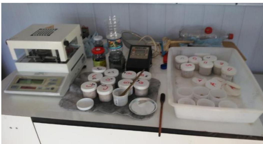
Bancada e materiais para determinação da umidade
