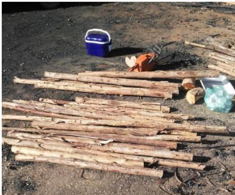
Amostragem da madeira para determinação da umidade.
