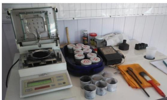
Aparato para determinação de umidade – Determinador Marte – Mod. ID 200
