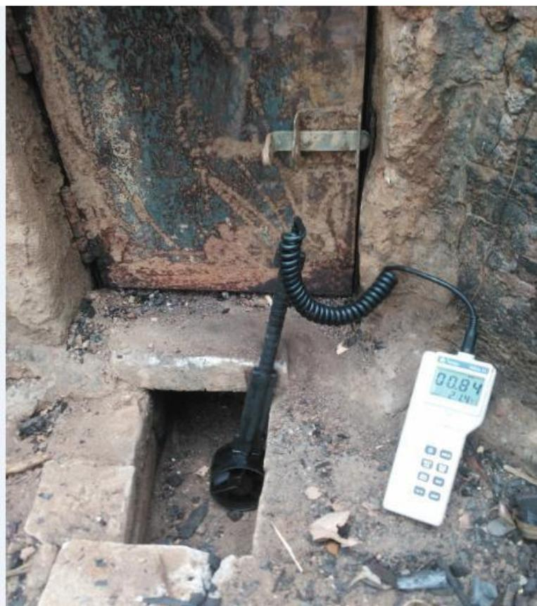
Vista da medição da velocidade de ar na entrada da fornalha.
