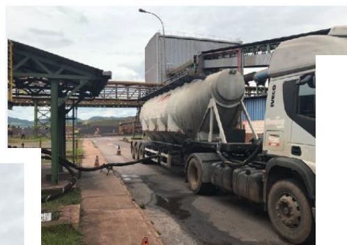
Foto 3: Descarga do pó de injeção (carvão vegetal moído) na unidade de dosagem e transferência. Fonte: VSB
