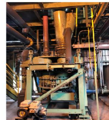
Foto 4: Sistema de dosagem e transferência do pó de injeção. Fonte: VSB
