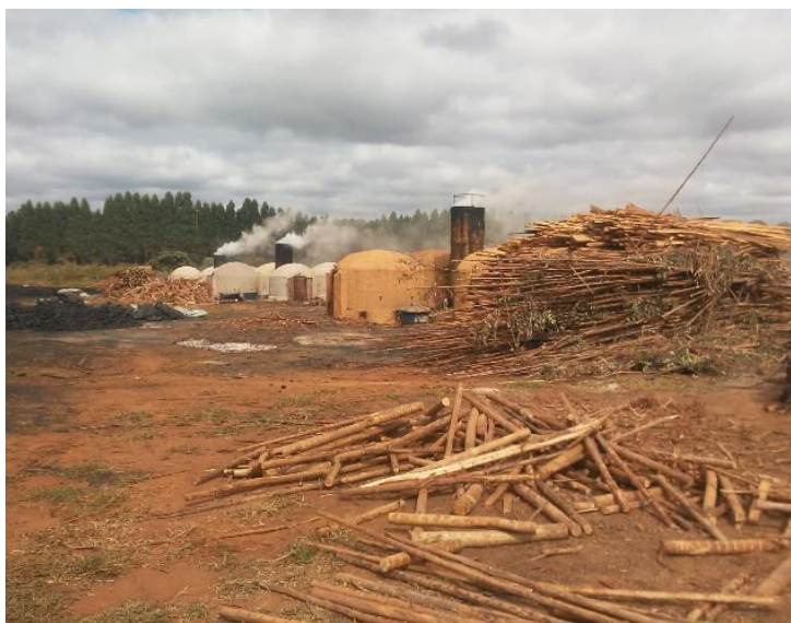
Foto 1: Unidade de produção da Capivari Madeiras em Itamarandiba com sistema fornos-fornalha
