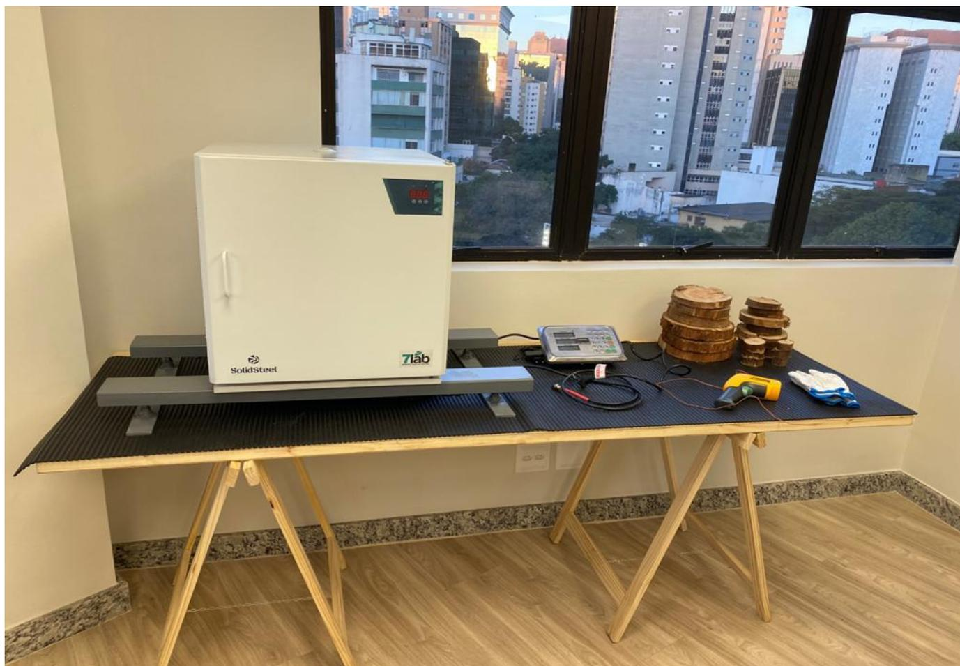
Estufa para determinação da umidade da madeira.
