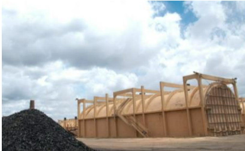
Figura 4: Forno retangular de alvenaria modelo RAC700.
