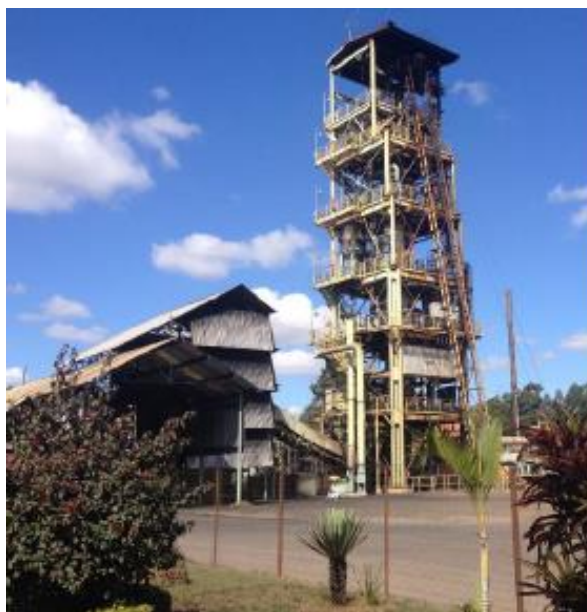
Figura 10: Reator de carbonização contínua Carboval.
