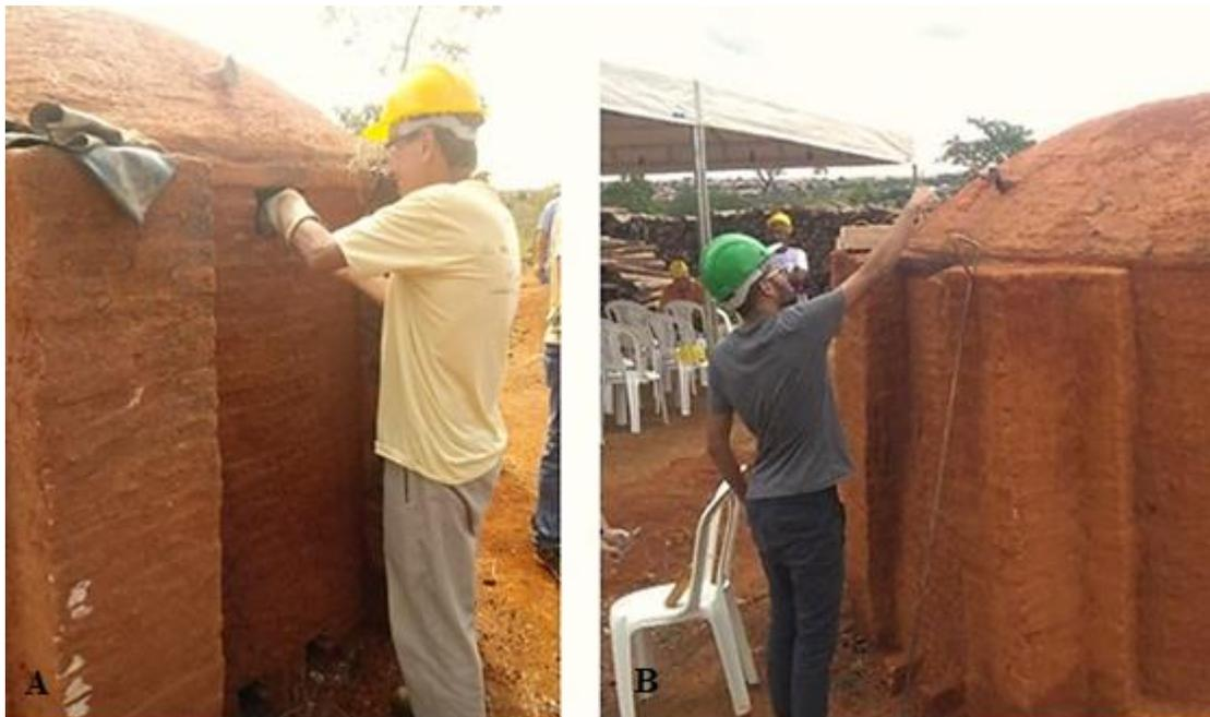
Figura 5. A) Ignição dos fornos; B) Monitoramento de temperatura com pirômetro.
