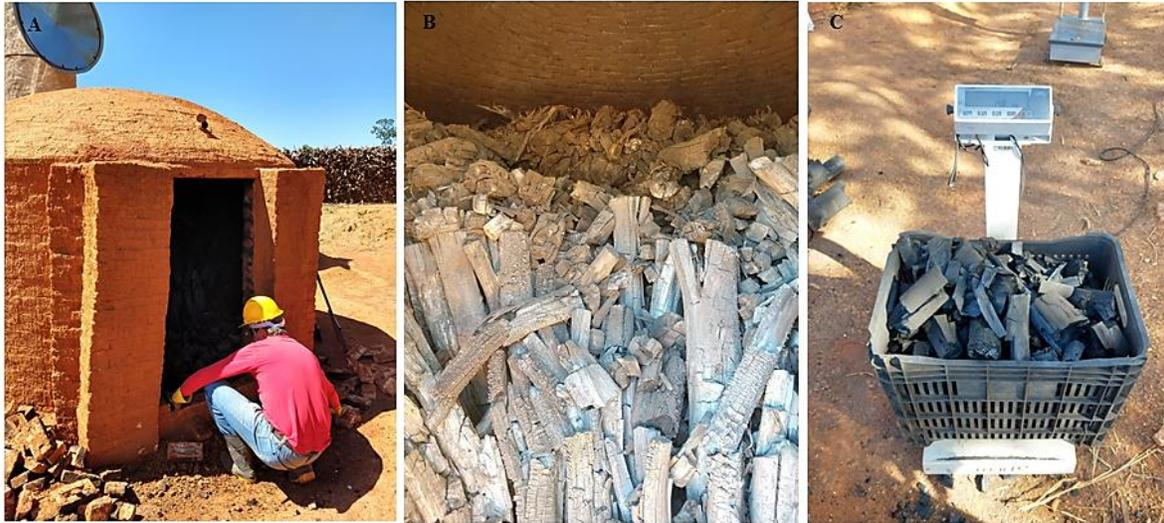
Figura 7: Abertura do forno após carbonização (A), Vista interior do forno (B), pesagem do carvão vegetal (C).
