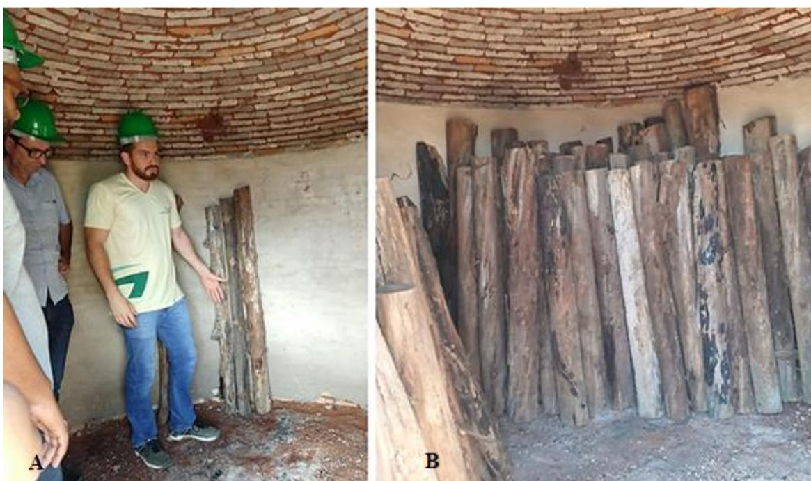
Figura 3. A) Explicação sobre enchimento dos fornos conforme a metodologia descrita pelo projeto Siderurgia Sustentável; B) Toras de eucalipto dentro do forno.
