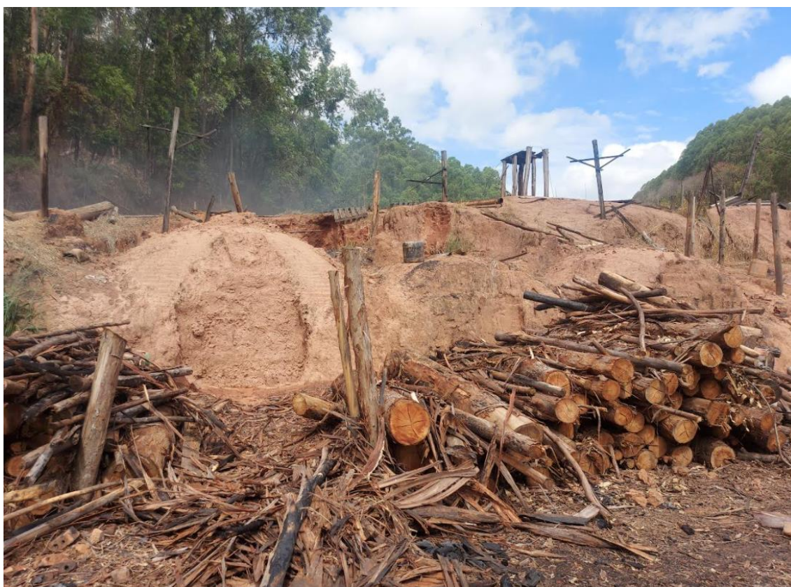
Fig.17 – Imagem dos fornos de encosta sem sistema de coleta dos gases condensáveis
