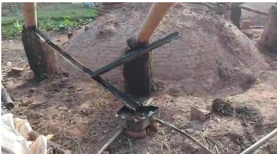
Fig.9 – Detalhe do sistema de escoamento do extrato (fumaça líquida) com canalização aberta do produto para os tanques de coleta
