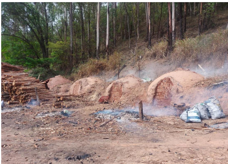
Fig.16 – Imagem dos fornos de encosta sem sistema de coleta dos gases condensáveis
