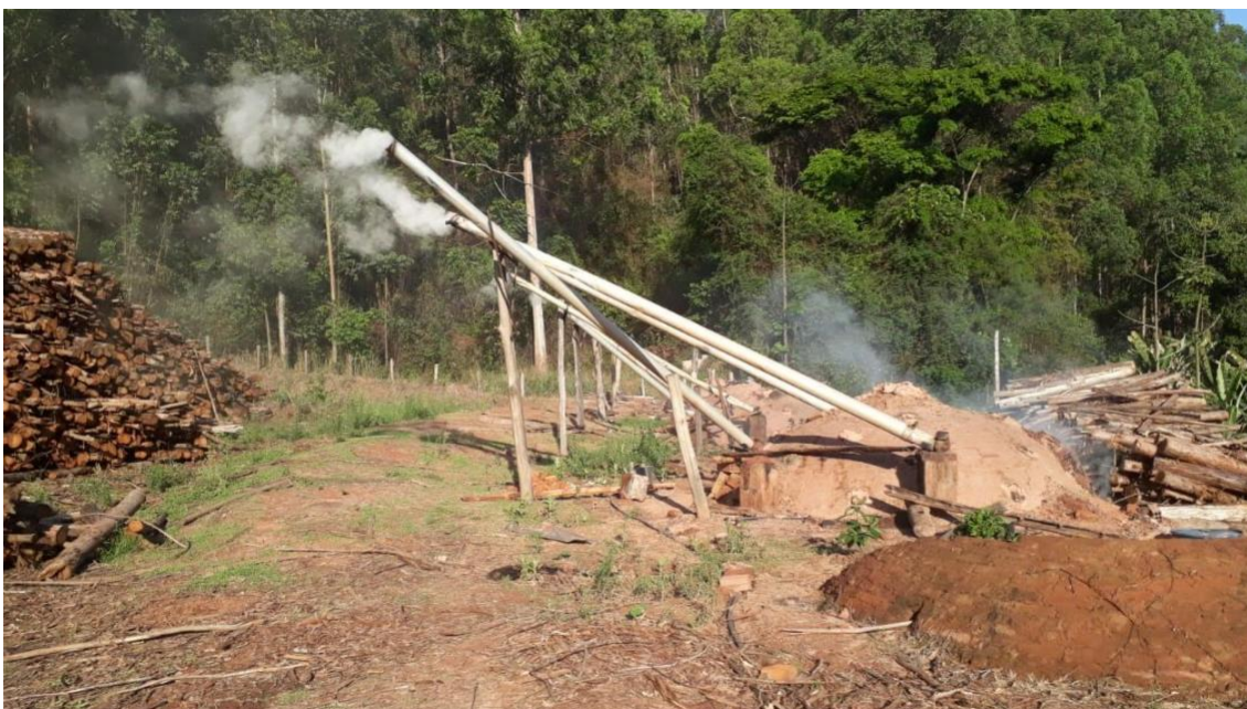
Fig.8 – Fornos com sistema de coleta do extrato – 1 a 3 canos de alumínio por forno
