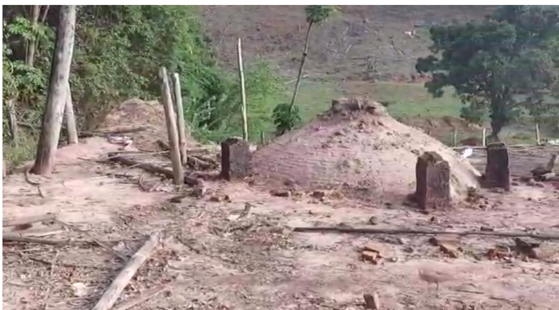
Fig.2 – Imagem do topo do forno de encosta com capacidade de 20st de lenha, sem sistema de captação dos gases condensáveis
