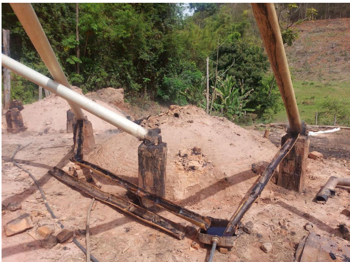
Fig.10 – Detalhe do sistema de escoamento do condensado
