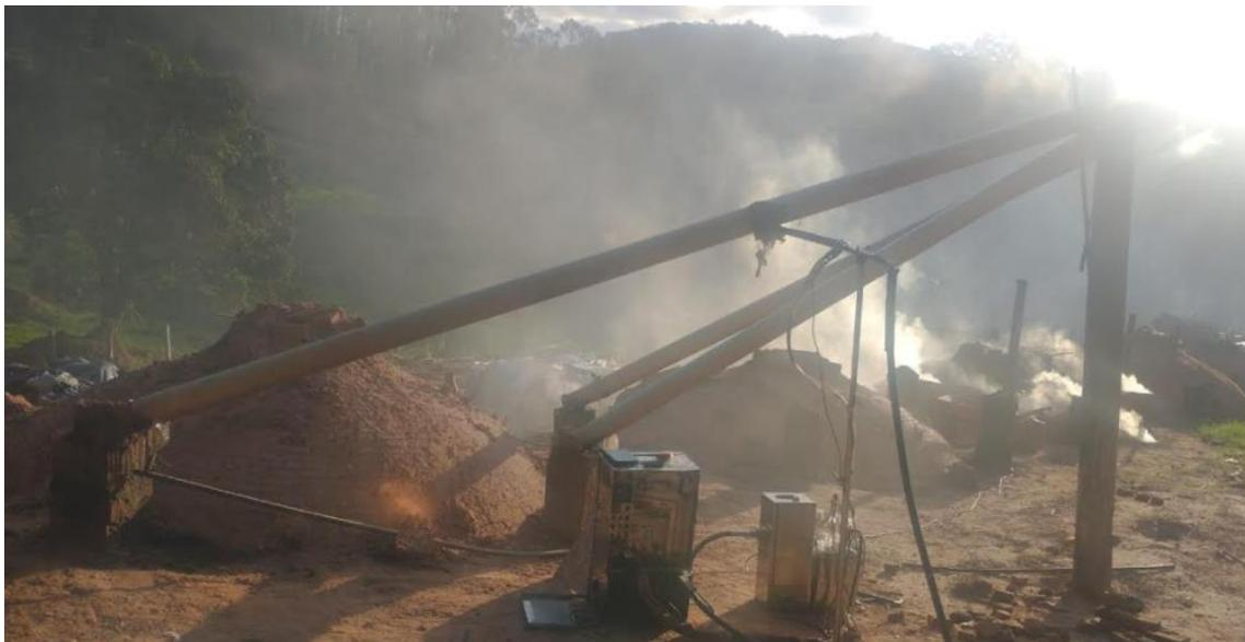
**Fig. 05** - Imagem do ponto de amostragem dos gases na tubulação de PVC
