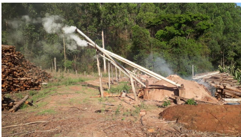
Fig. 08 – Fornos com sistema de coleta do extrato – 1 a 3 canos de alumínio por forno
