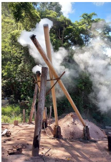
Fig. 17 – Emissão dos gases no forno 30 (sistema antigo de coleta)
