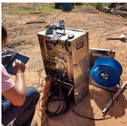
Fig. 21 – Equipamento de coleta e análise dos gases
