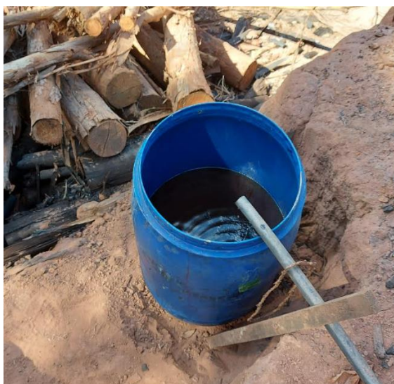
Fig. 25 – Coleta da fumaça condensada no Forno 19
