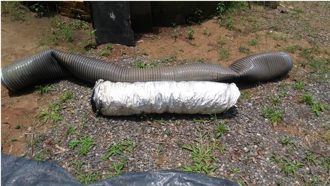
Figura 18 - Tubo de conexão de entrada no recuperador (aluminizado) e na saída (cinza)
