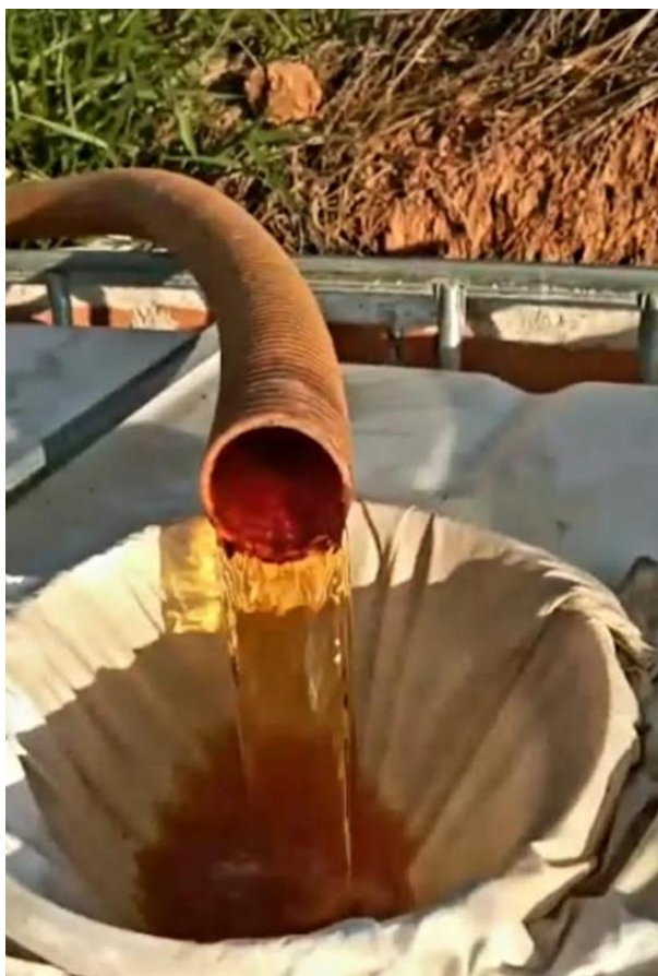
Fig. 30 – Imagem da fumaça líquida sendo filtrada para o tanque de coleta
