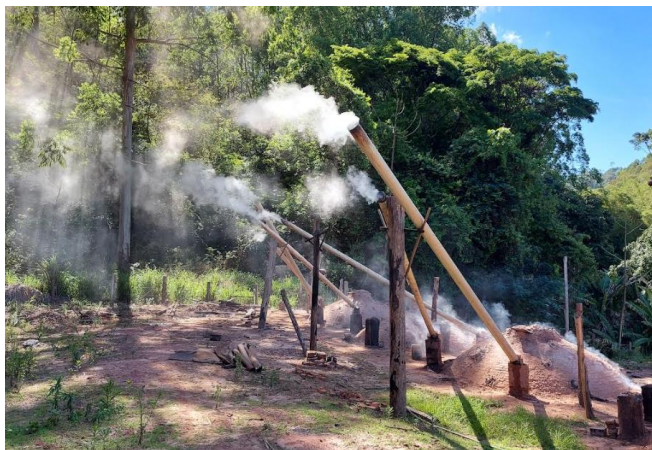
Fig. 18 – Emissão dos gases com baixa eficiência de condensação (sistema antigo)
