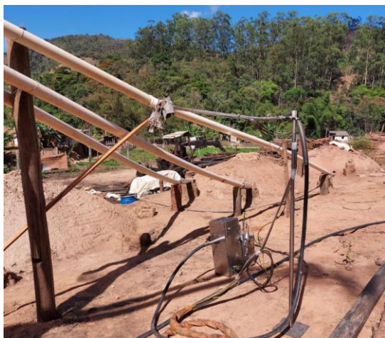
Fig. 20 – Sistema de coleta e monitoramento dos gases no Forno 19
