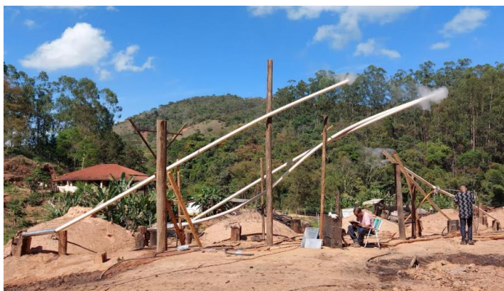
Fig. 19 – Sistema novo com melhor eficiência de condensação (Forno 19)
