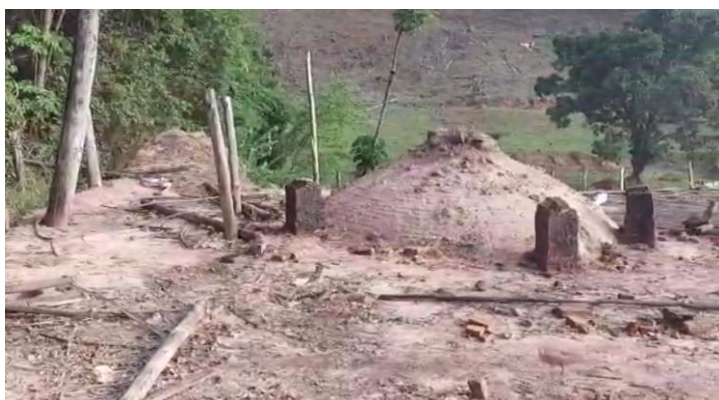
Fig. 02 – Imagem do topo do forno de encosta com capacidade de 20st de lenha, sem sistema de captação dos gases condensáveis
