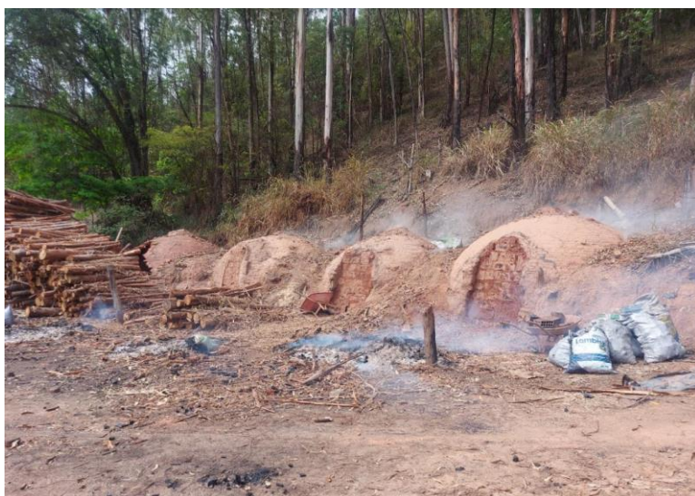
Fig. 15 – Imagem dos fornos de encosta sem sistema de coleta dos gases condensáveis
