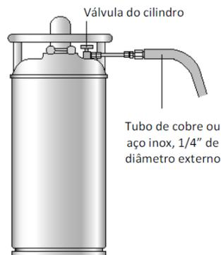
**Figura 3** - Configuração do cilindro de N<sub>2</sub>.
