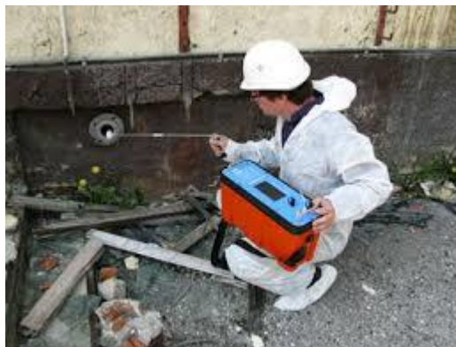
Figura 10 - Detecção de vapores de mercúrio em uma área contaminada
