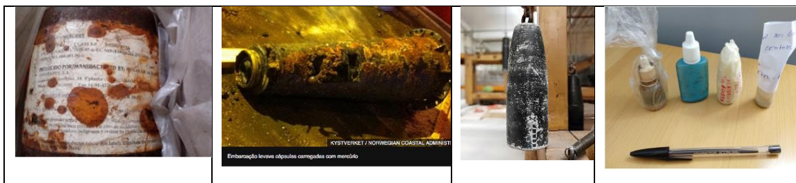
Figura 5– Embalagens de mercúrio danificadas, corroídas e incorretas.
