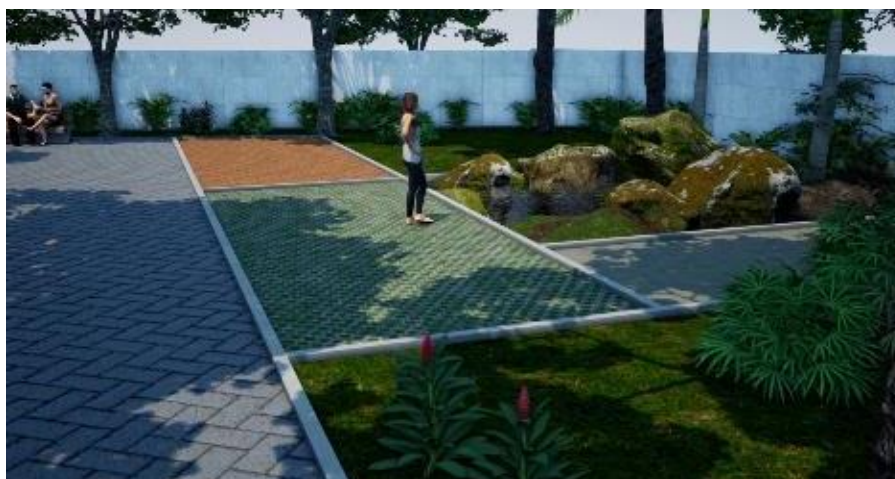
Figura 7 - Detalhe dos tipos de piso drenante e da proteção de uma das 14 nascentes existentes no projeto.
