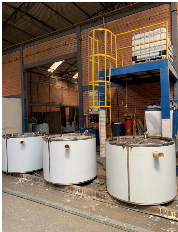
Figura 15. Setor de produção de poliuretano, com a estrutura para armazenamento do container IBC contendo poliol. Fonte: Refribrasil, arquivos enviados por email.
