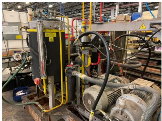
Figura 18. Uso de polioli e equipamentos para produção de poliuretano. Fonte: Ártico, email enviado por Fabiano D. Meinicke.
