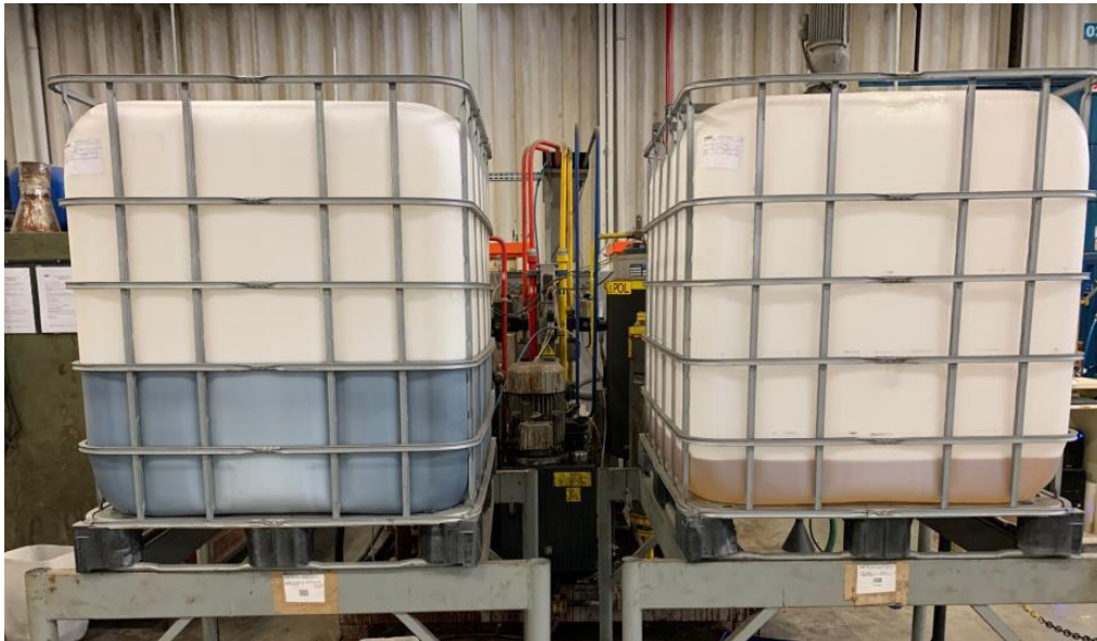
Figura 17. Containers com isocianato e polioli para produção de poliuretano. Fonte: Ártico, email enviado por Fabiano D. Meinicke.
