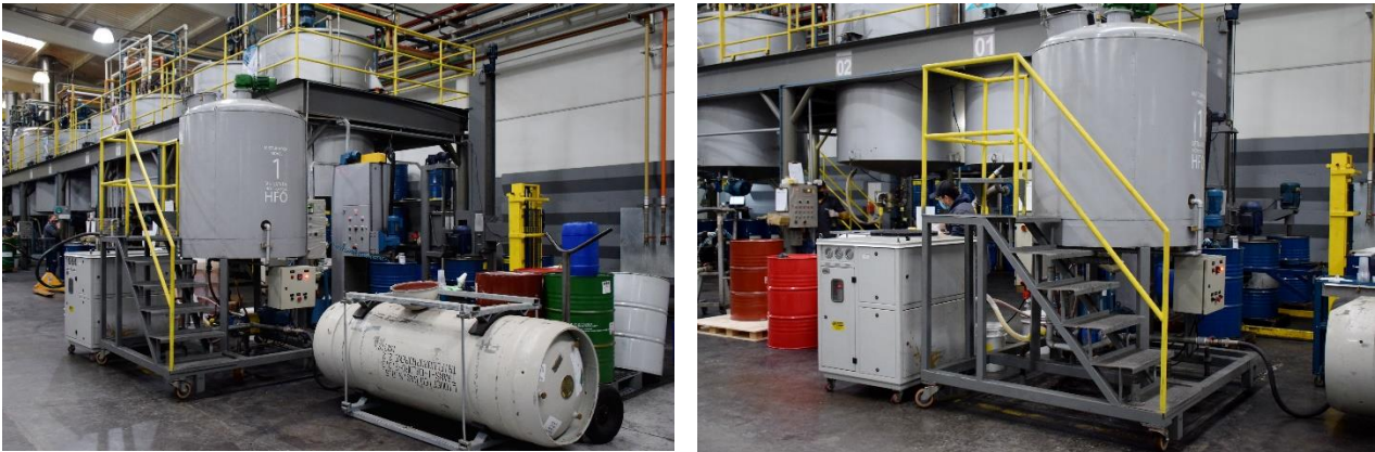
Figura 12. Área interna da Flexível: misturador móvel onde é colocado o gás para transferir para os reatores. Fonte: Flexível, arquivos enviados por email.
