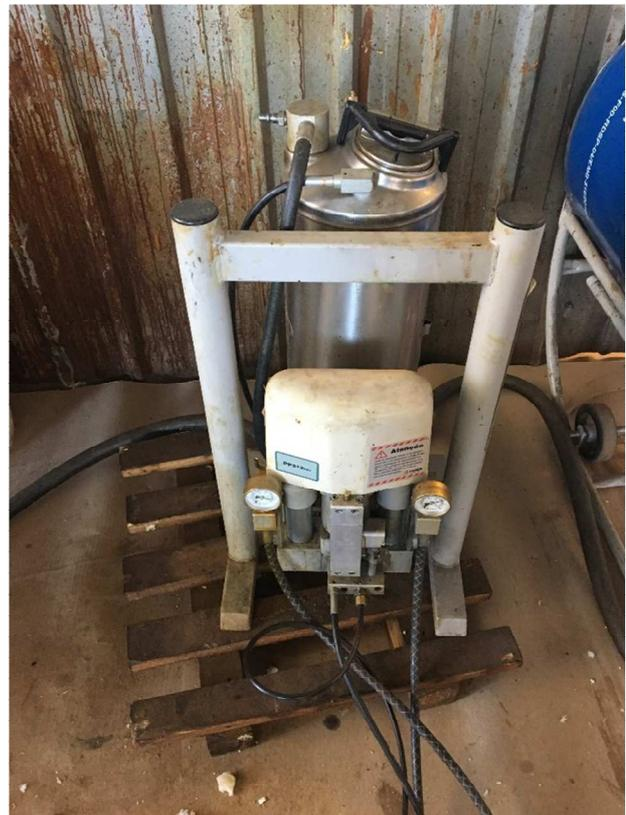
Figura 12. Armazenamento de produtos químicos e injetora de baixa pressão.
