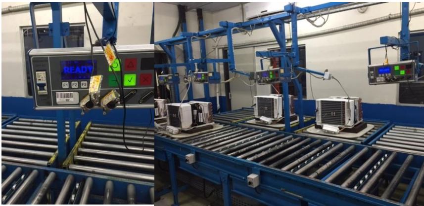
Figura 7: Detecção de vazamentos
