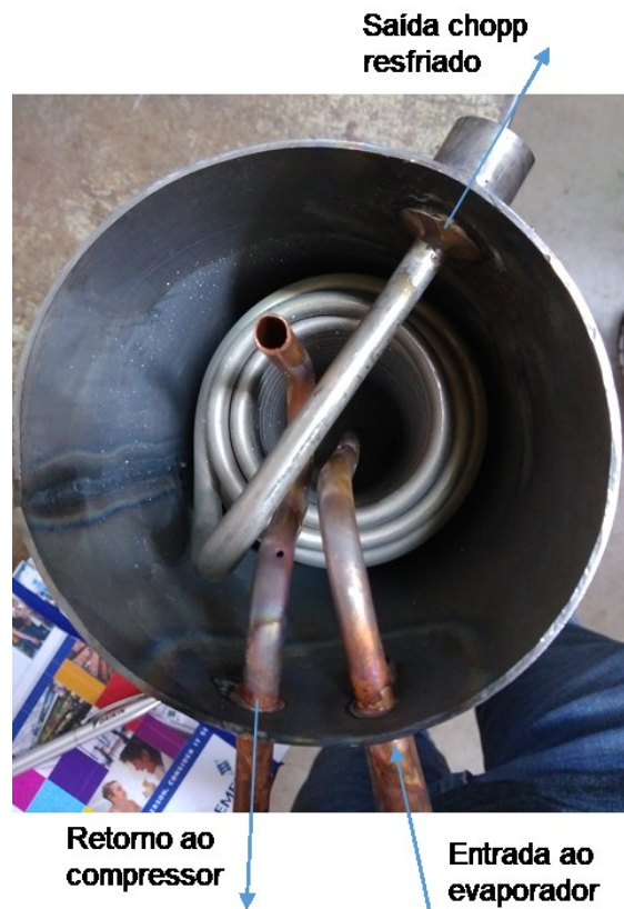
Figura 2.2 Evaporador inundado aberto utilizado no resfriador.
