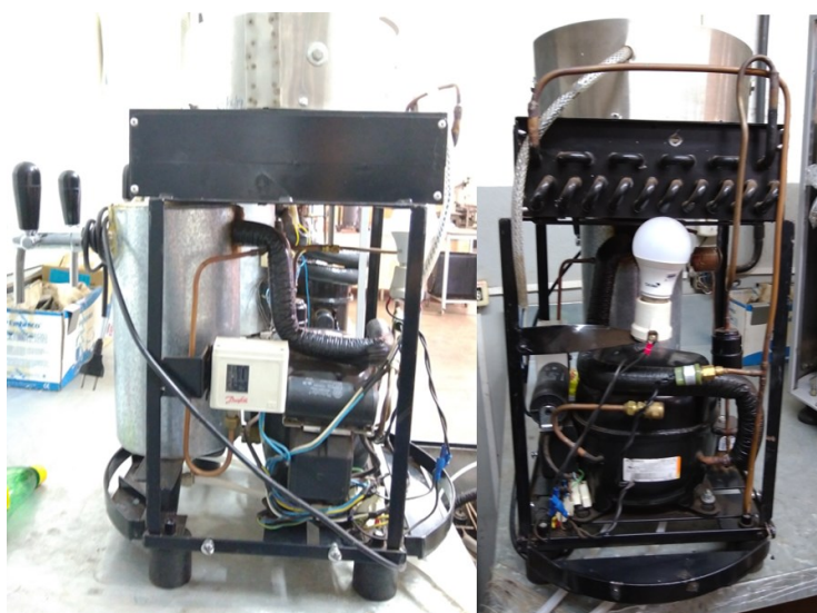
Figura 2.3 - Resfriador de chope selecionado para conversão.
