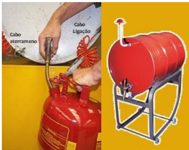
Figura 11.9.1. Válvula de segurança com fecho automático e respiro de segurança
